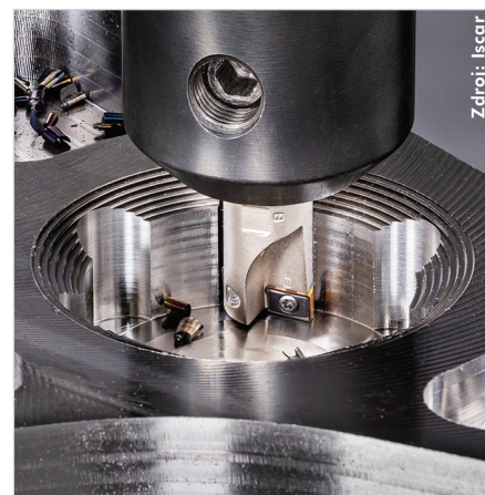
Nový kombinovaný nástroj MDR z řady Quick-D-Mill lze využít pro frézování i vrtání.
